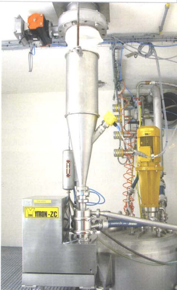
YTRON-ZC 3 kapcsolószekrénnel és portölcsérrel, manuális poradagolóhoz
