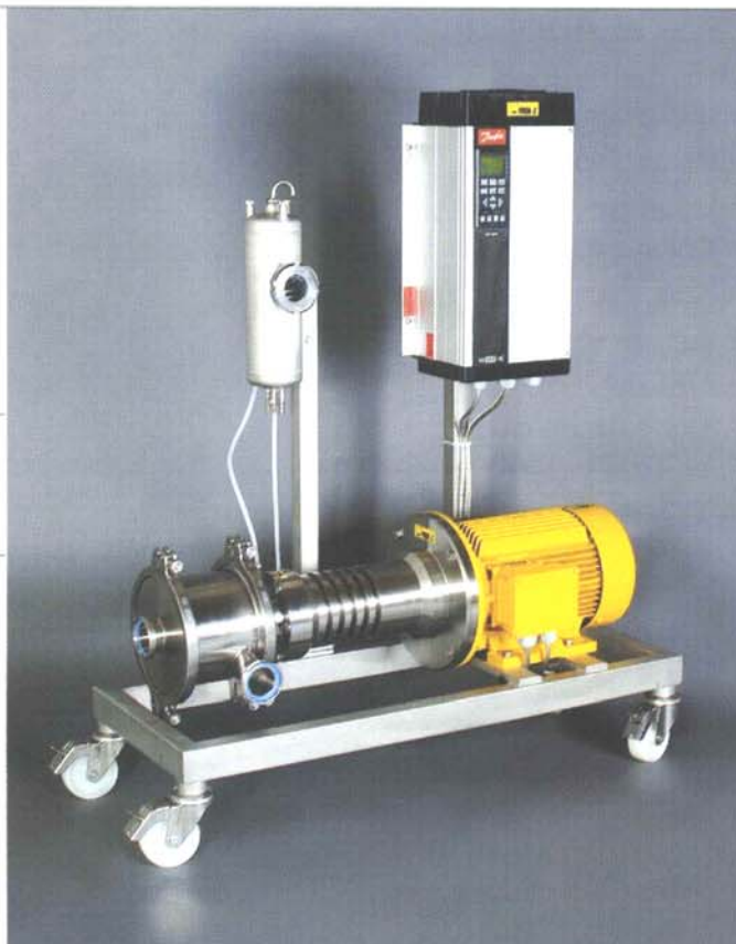
YTRON-Z mobil szerkezetben frekvencia szabályzóval.
