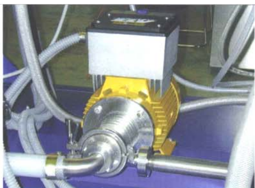
YTRON-Z integrált frekvencia szabályzóval Alkalmazás: Sűrítő alapanyagok folyamatos gyártása textilipari célokra.
