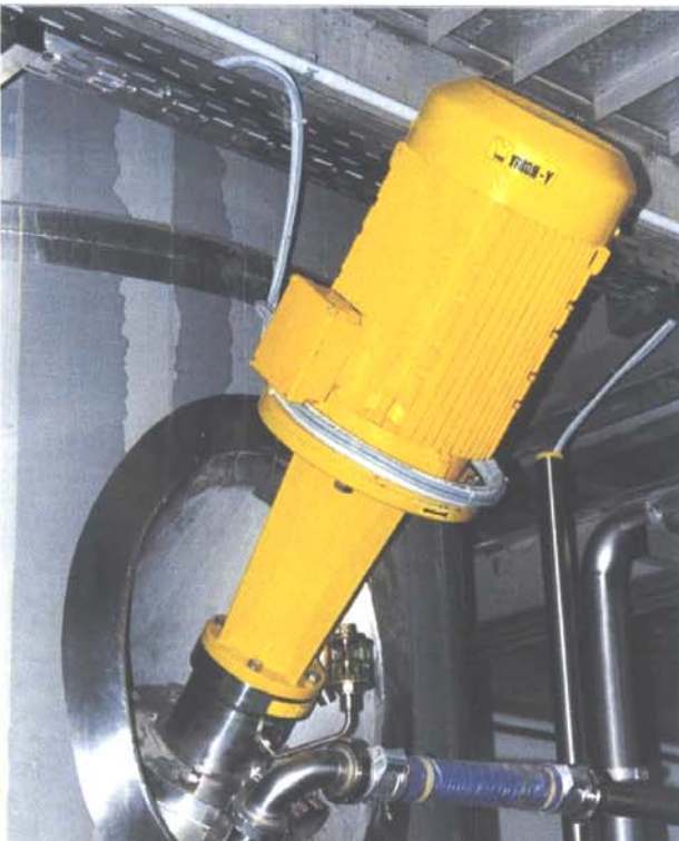
YTRON-Y tankperemes kivitelben, zárt tartályba építve, samponféseségek gyártásánál
