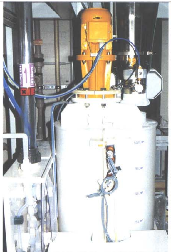
YTRON -Y rögzített peremre építve, nyitott keverőtartályra szerelten, csi-szolóanyag szuszpenziók gyártásánál.
