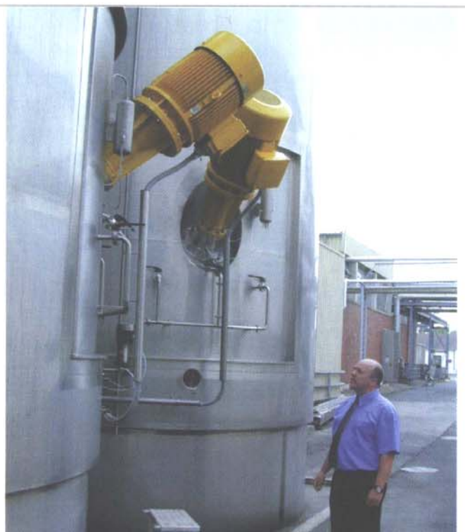
YTRON – tankperemes kivitelben, folyadékszint alatt beépítve, 100.000 literes tejfeldolgozási folyamat tartályokban
