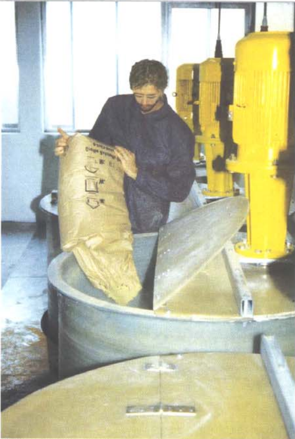
YTRON-Y nyitott keverő tárolóban, kerámia bevonatok és mázok készítéséhez
